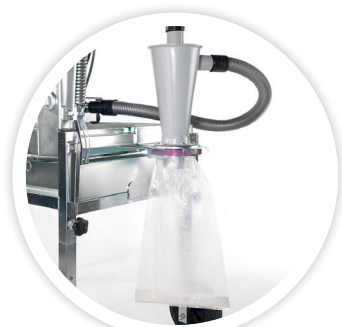
Dubbele filtering door een voorafscheidercyclus (90% stof)
